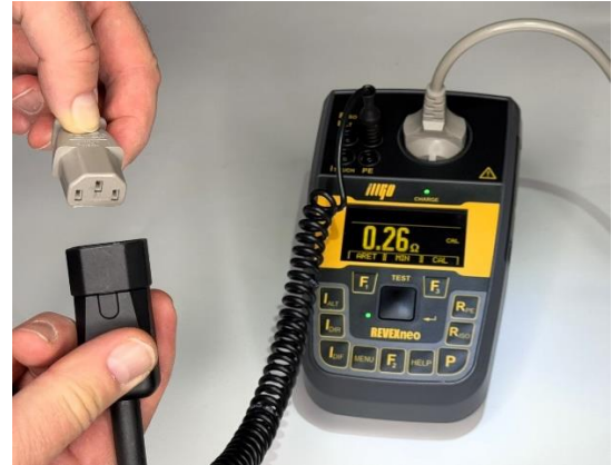
P 8031 - Adaptér pro testování PE vodiče odnímatelných přívodů a UPS
