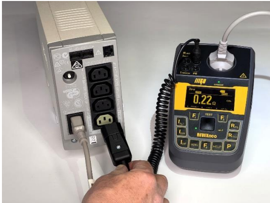
P 8031 - Adaptér pro testování PE vodiče odnímatelných přívodů a UPS
